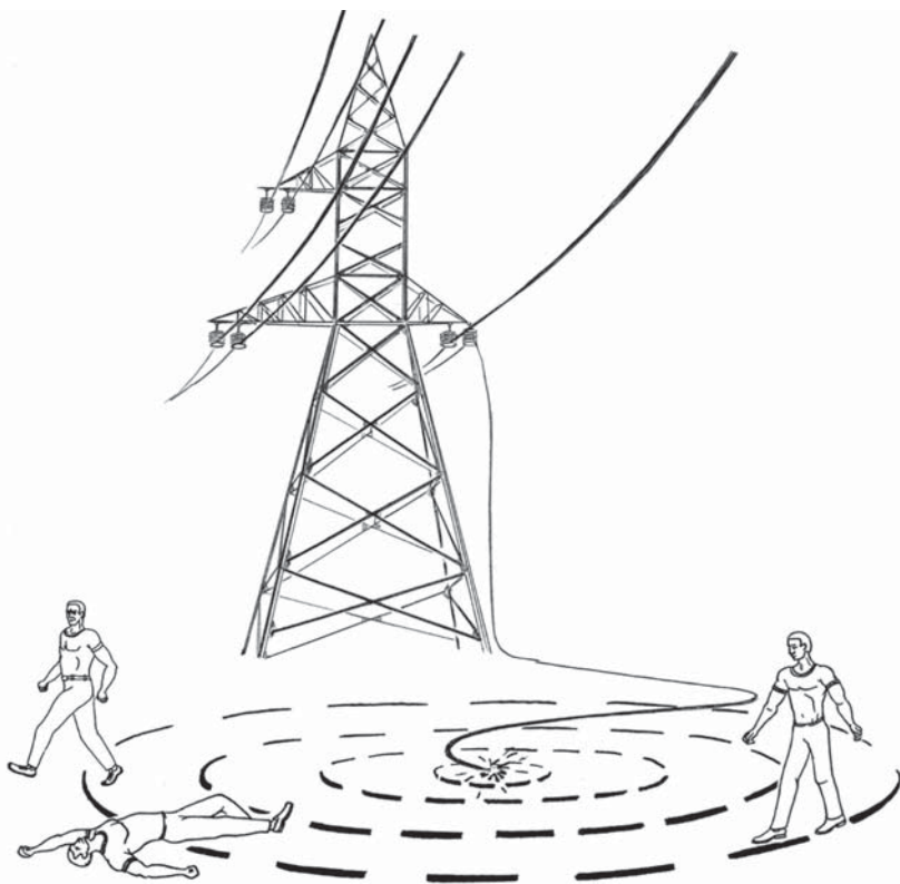
Рис. 1. Зависимость величины шагового напряжения от положения человека
